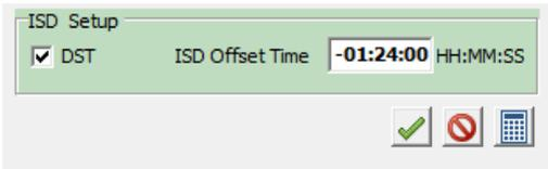
Mit der Checkbox [DST] kann die astronomische Berechnung auf Sommerzeit gestellt werden. Ohne aktivierte Checkbox wird mit der Standardzeit geschaltet.
