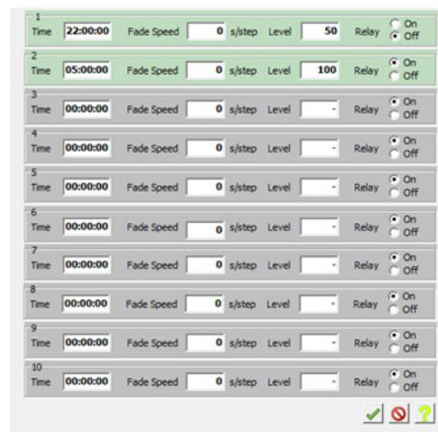
Im Dimming Engine 1 werden die Schaltzeiten und Dimmstufen für den Normalbetrieb festgelegt. Zeiten müssen chronologisch eingetragen werden. Für jede Schaltzeit kann ein Fading, ein Dimmlevel und ein Schaltzustand des Umschaltrelais festgelegt werden.
