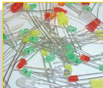
Diodi luminosi in corpi di plastica colorati
