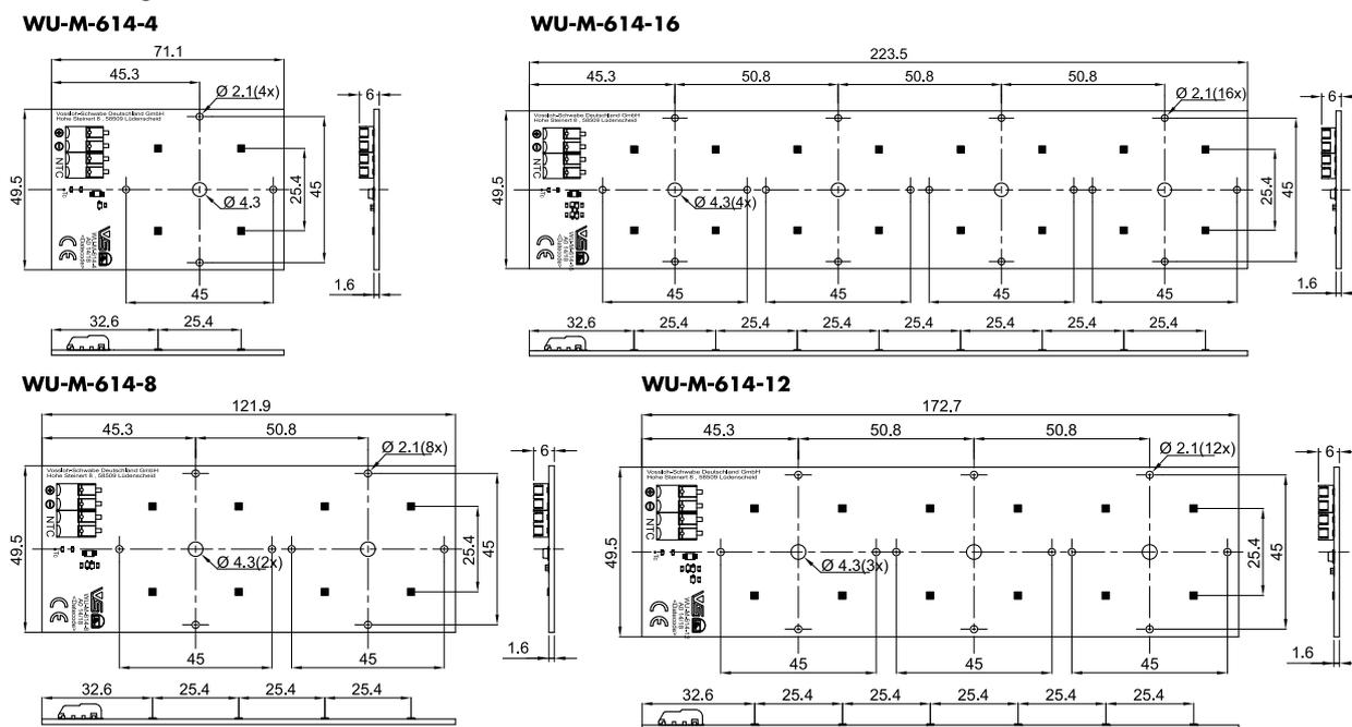
Alle Löcher mit  $\varnothing 2,1$  mm sind Befestigungslöcher für Optiken. | Alle Löcher mit  $\varnothing 4,3$  mm sind Befestigungslöcher für die Platine.
