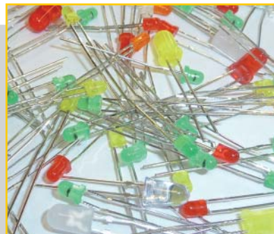
Diodes électroluminescentes en boîtier plastique multicolore
