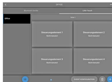
Nach erfolgreichem Anlegen der Schaltflächen, müssen diese nun mit Funktionen versehen werden. Mittels Touch wählen Sie die gewünschte Schaltfläche aus, benennen diese ("Titel") und weisen dieser dann unter "Typ" eine Funktion zu. Auf **SPEICHERN** drücken und das Fenster schließt sich.
