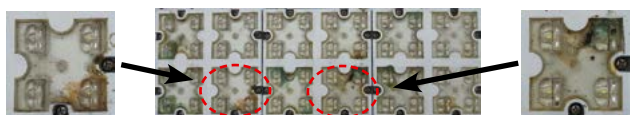
Abbildung 16: Beispiel eines LED-Moduls (WU-M-425), das in einer Umgebung mit hohem Salzgehalt betrieben wird
